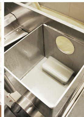
Do jímky proudí zpět čistá chladicí kapalina
